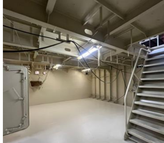
Ilustración 31. POC - Pintura bloque ECR
